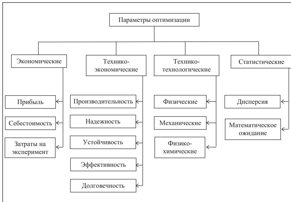
Рис. 1. Схема классификации параметров оптимизации
