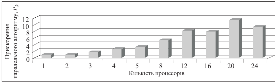
Рис. 3. Прискорення паралельного алгоритму P_k для розв'язання задачі на СКІТ-3
